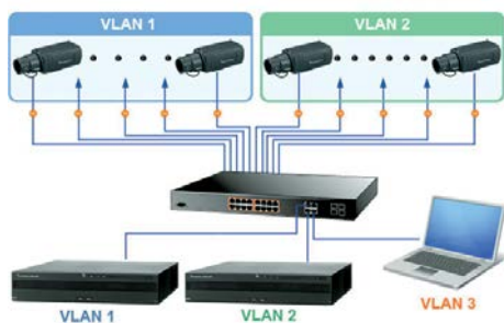
Rys. 3. Separowanie domen rozgłoszeniowych poprzez zastosowanie VLAN
