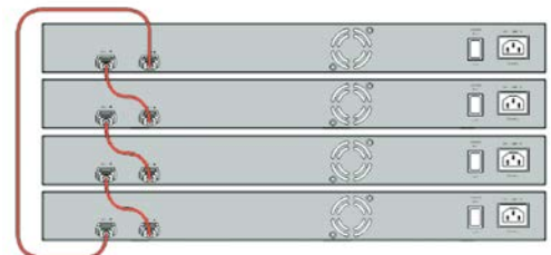
Topologia typu pętla (Ring Topology)
