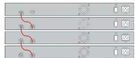
Topologia typu szereg (Chain Topology)
